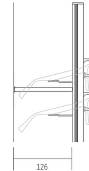
Required distance between the rod and the back surface is 126 mm. La distanza tra la barra e il retro è di 126 mm.
